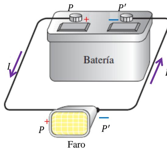
**Figura 5.14** Circuito de corriente del encendido de un faro para vehículo
