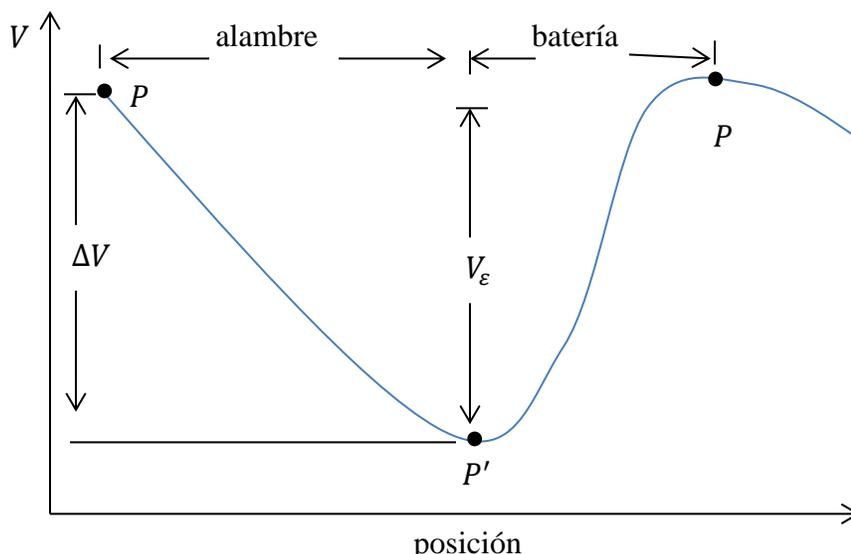
**Figura 5.13** Grafica del potencial eléctrico, o energía potencial por coulomb de carga, en función de la posición a lo largo del conductor, para el circuito 1. El potencial es máximo en el punto *P* (el polo positivo de la batería) y mínimo en el punto *P'* (polo negativo).
