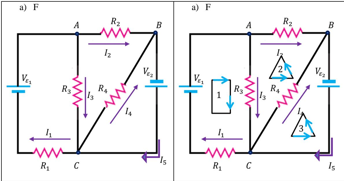
**Figura 5.24** Un circuito con varias espiras. a) Circuito con sus cinco corrientes separadas. b) El mismo circuito con tres mallas (1,2 y 3) identificadas
