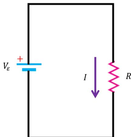
**Figura 5.16** Un circuito simple con una fuente de fem y un resistor
