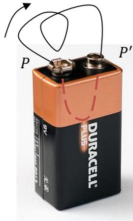
**Figura 5.12** Un alambre resistivo conectado a las terminales de una batería. La energía potencial de una carga (positiva) es alta, cuando está en la terminal positiva  $P$  de la batería. La energía potencial decrece en forma gradual a medida que la carga recorre el alambre hacia la terminal negativa  $P'$ . Después, la energía potencial vuelve a aumentar a medida que la carga atraviese la batería (línea interrumpida), de  $P'$  a  $P$ .
