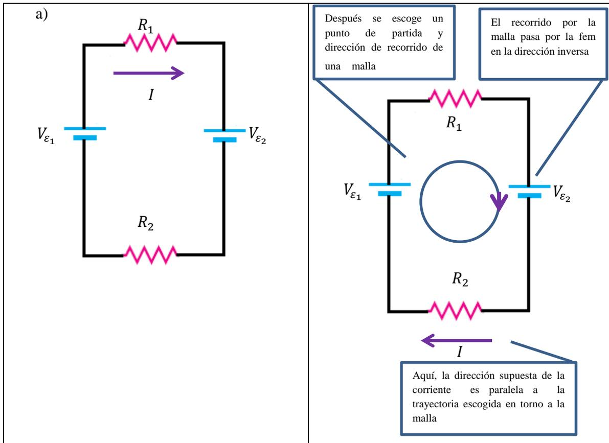
**Figura 5.21** a) Dos fuentes de fem y dos resistores. b) Las mismas fuentes de fem y los mismos resistores, habiendo elegido una trayectoria para aplicar la regla de voltaje de Kirchhoff.
