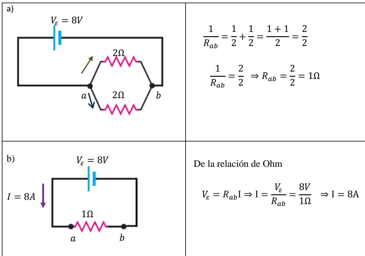
**Figura 5.20** Esquema del circuito formado por la fuente y las bombilla en paralelo
