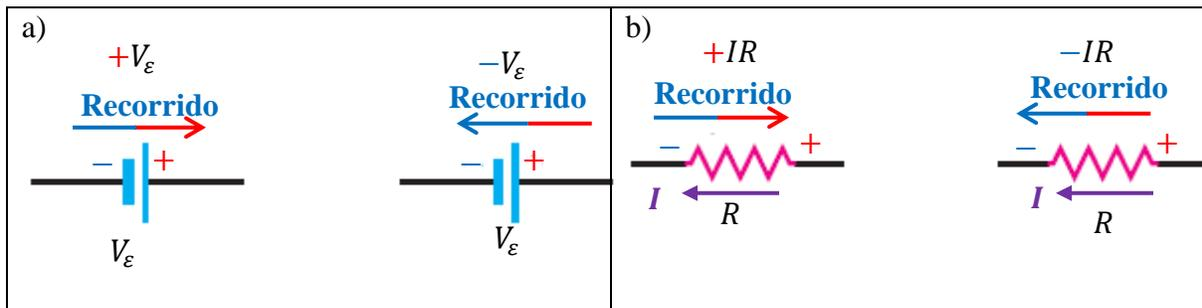
**Figura 5.23** Uso de las convenciones de signos cuando se aplica la regla de Kirchhoff de las espiras. En cada parte de la figura “Recorrido” es el sentido en que imaginamos ir alrededor de la espira, que no necesariamente es el sentido de la corriente.
