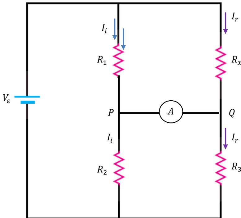
Figura 5.27 Esquema de un puente de Wheatstone.
