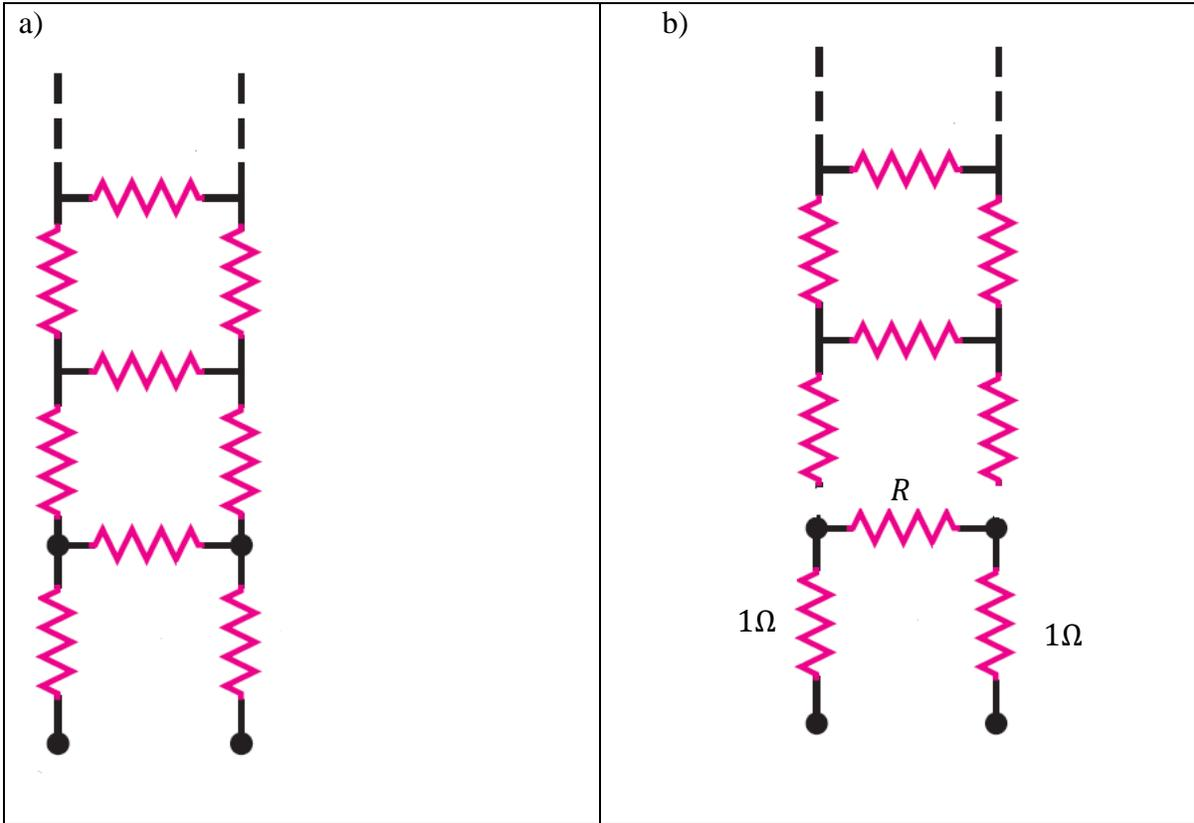
**Figura 5.30** a) Una escalera infinita de resistores. Las terminales se marcan con el par de puntos. b) Se ha quitado un peldaño de la escalera
