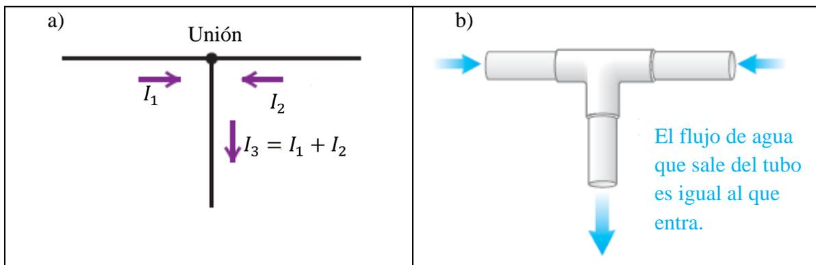
**Figura 5.22** a) Regla de Kirchhoff de las uniones, b) Analogía de la tubería de agua para la regla de Kirchhoff de las uniones.
