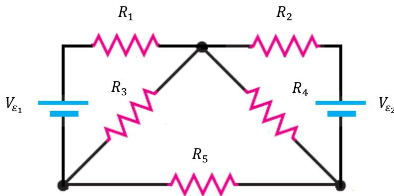
**Figura 5.28** Dos fuentes de fem y cinco resistores
