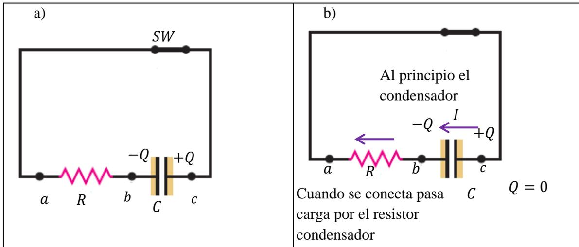
**Figura 5.33** Descarga de un capacitor, ahora el interruptor (SW) se abre.
