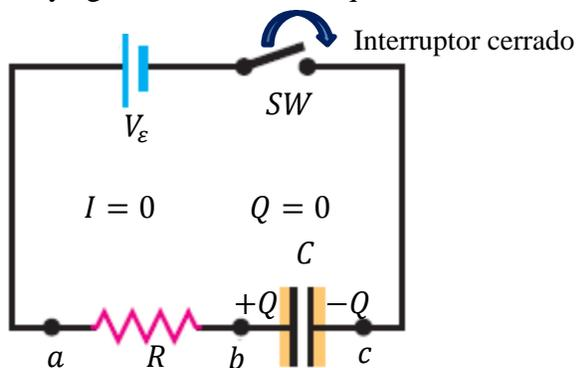
**Figura 5.31** Carga de un capacitor Cuando el interruptor se cierra (en  $t = 0$ ), la corriente pasa de cero a  $\frac{V_\epsilon}{R}$ . A medida que transcurre el tiempo,  $Q$  se acerca a  $Q_f$ , y la corriente  $i$  se acerca a cero.
