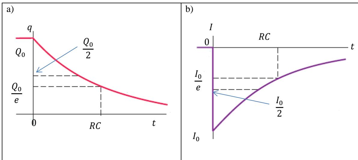
**Figura 5.34** Capacitor en un proceso de descarga. a) La carga  $q$ , b) la corriente  $I$ . En función del tiempo
