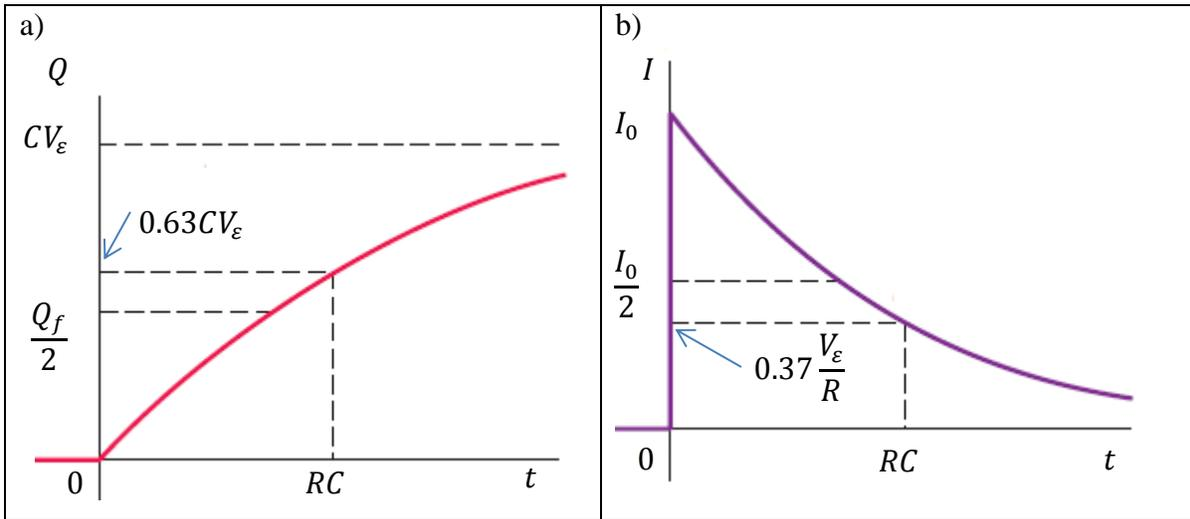
**Figura 5.32** a) Carga en el capacitor del circuito  $RC$  en función del tiempo, b) Corriente en el capacitor  $RC$  en función del tiempo.
